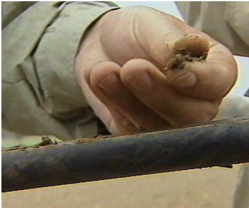
Feststellen der Bodenart durch die Fingerprobe
